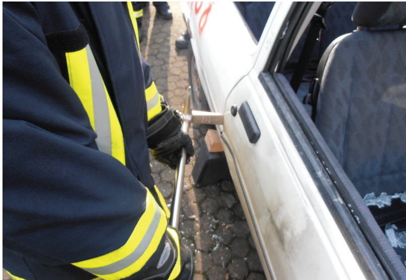
Abb. 12: Einsatz eines Halligan-Tools
