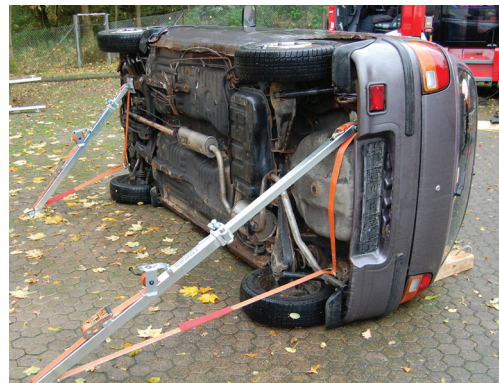
Abb. 6: Stabilisieren mit einem Abstützsystem
