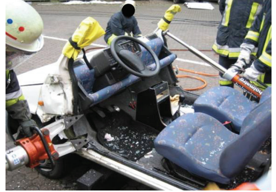
Abb. 24: Vorderwagen abklappen parallel mit Spreizer und Rettungszylinder
