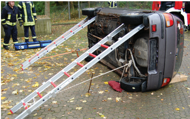
Abb. 5: Stabilisieren mit Steckleiterteilen
