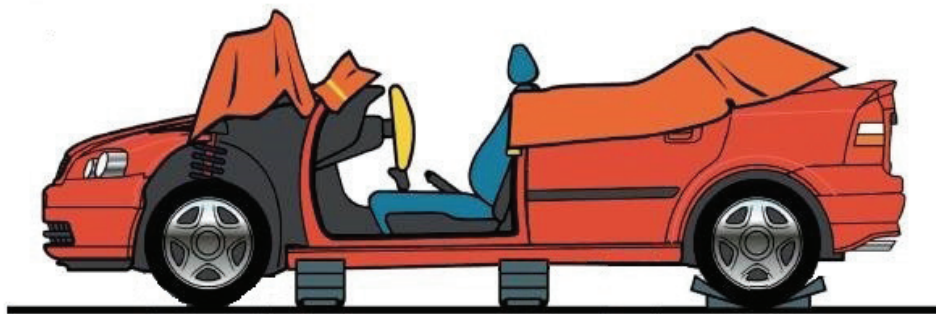
Abb. 21: Komplette Entfernung des Daches
