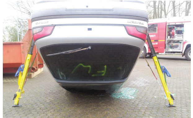
Abb. 10: Stabilisierung mit einem Abstützsystem
