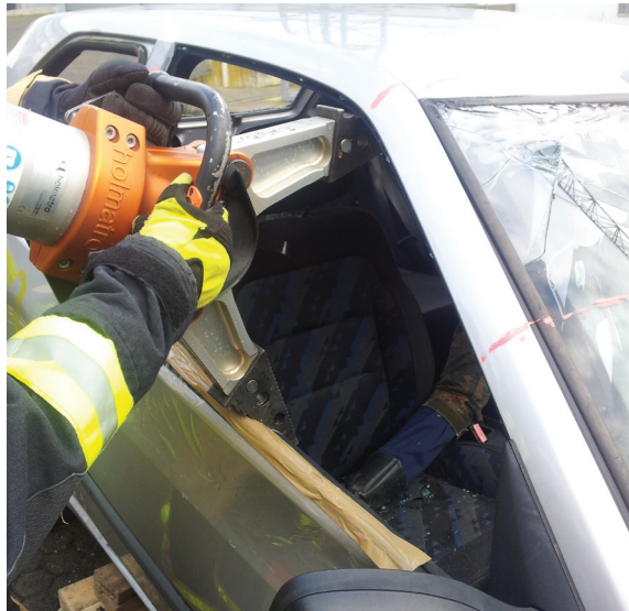
Abb. 14: Spreizer zwischen Dach und Türoberkante
