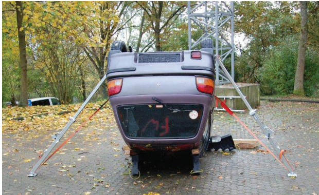
Abb. 9: Stabilisierung mit einem Abstützsystem
