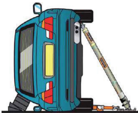
Abb. 7: Stabilisieren mit einem Abstützsystem
