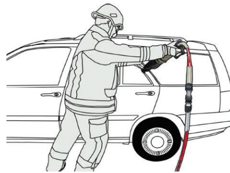
Abb. 17: Fensterrahmen um eigene Achse drehen
