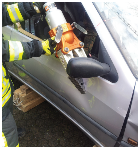
Abb. 15: Zusammendrücken der Fahrzeugtür
