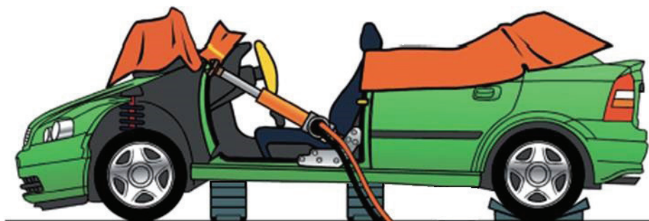
Abb. 22: Abklappen des Vorderwagens
