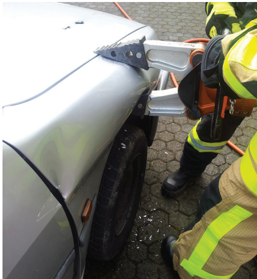
Abb. 13: Zusammendrücken des Kotflügels
