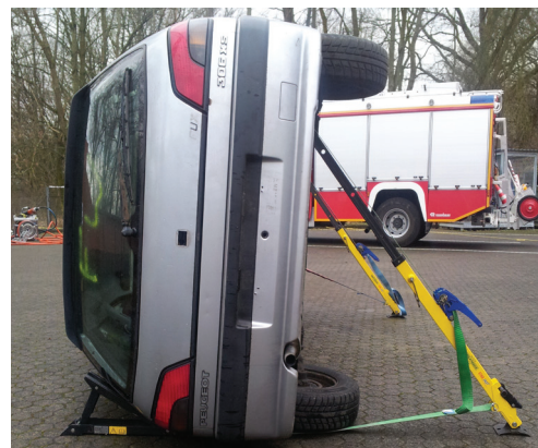
Abb. 8: Stabilisieren mit einem Abstützsystem
