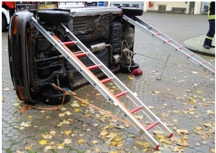
Abb. 51: Abstützen mit Steckleiterteilen
