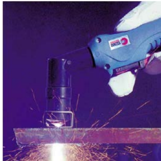
Abb. 49: Beginn auf der Werkstückoberfläche
