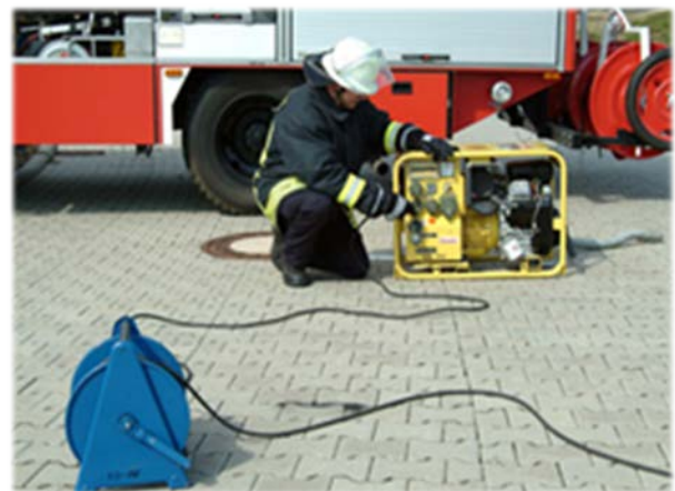
Abb. 7: Inbetriebnahme des Stromerzeugers
