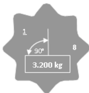
Abb. 16: Kennzeichnung einer Kette der Güteklasse 8
